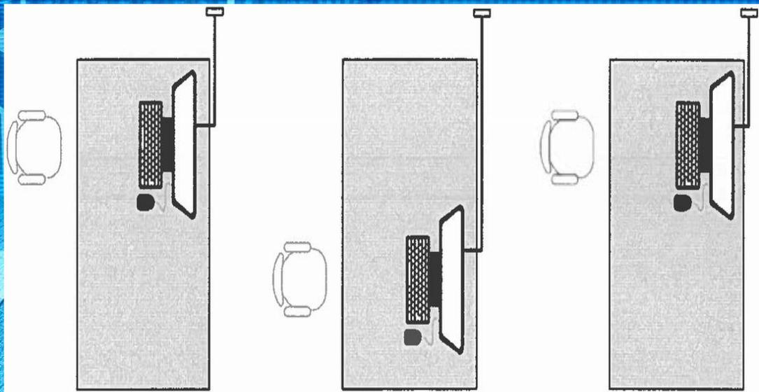
Рис. 3. Рекомендуемый возможный вариант рядного расположения рабочих мест
