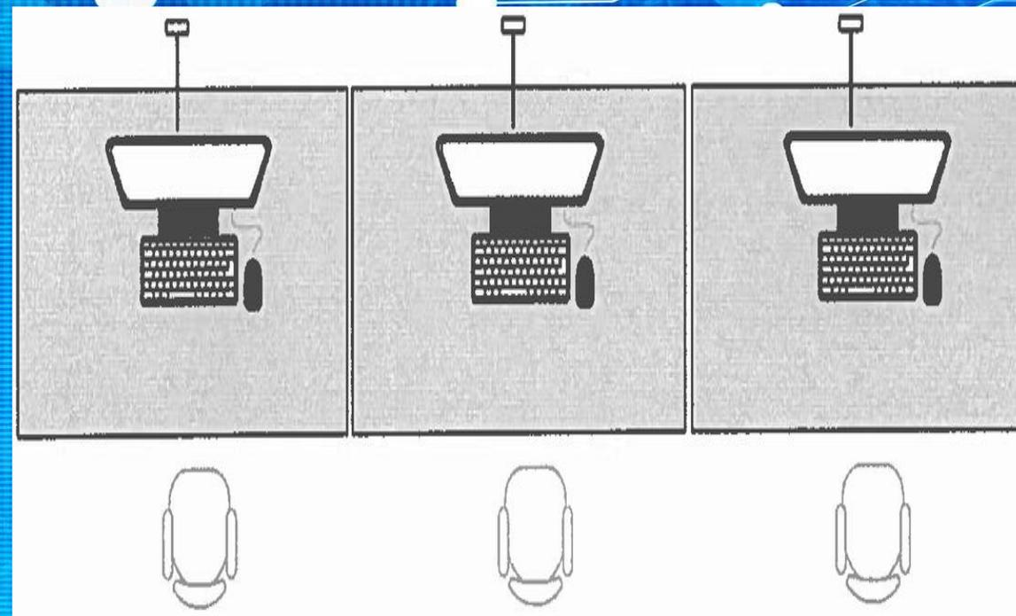
Рис. 6. Рекомендуемый вариант линейного расположения большого количества рабочих мест
